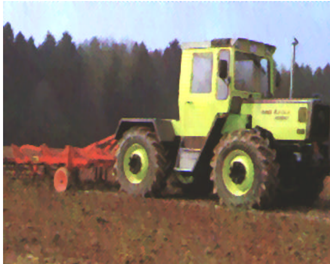
Figura 7: Tractor doble tracción de ruedas iguales 4WD con rodado single.
