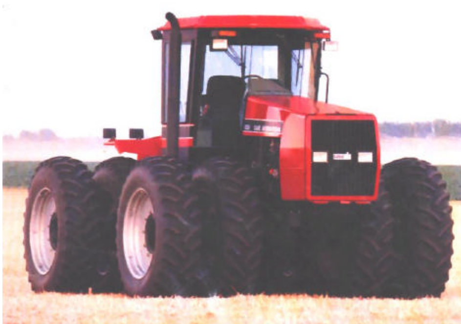
Figura 8: Tractor de chasis articulado doble tracción de ruedas iguales 4WD portando rodado dual.
